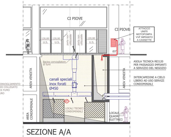
N.B. Le canalizzazioni di aerazione e di sovrappressione disegnate potranno subire modifiche di percorso o di sezione a causa delle possibili interferenze con gli impianti esistenti al piano cantine. Dette modifiche saranno stabilite in corso d'opera secondo permessi ed autorizzazioni condominiali.
